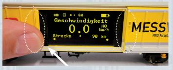
Ein kurzer Tastendruck wechselt die Displaysprache von Deutsch in Englisch. Touchsensible Flächen (in der Abb. weiß markiert) neben dem Display ermöglichen das Umschalten der Anzeigen! Hierzu braucht man nur die Flächen ohne Druck zu 0,5 Sekunden berühren!
